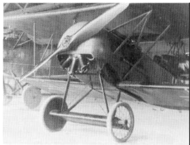
aus Stahlrohren und hatten V-Form, da sie an der Unterseite ja nur an einem Holm befestigt werden konnten.
