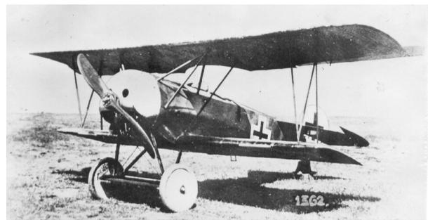
Die Konstruktion der V.9 basierte stark auf der des Dr.I. Der Rumpf war sogar weitgehend der gleiche. Nicht einmal die Aufnahme des Unterflügels wurde abgeändert. Auch das Rumpheck und das Leitwerk wurden beibehalten.
