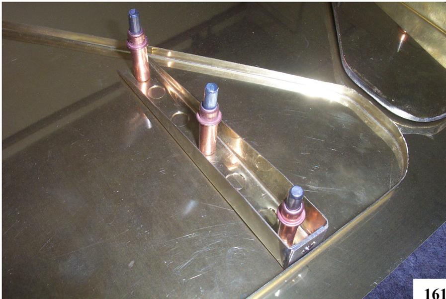
**161 u. 162. Während der Montage werden die einzelnen Blechteile mittels Clecos zusammengehalten. Anschließend wird vernietet und weich gelötet.**
