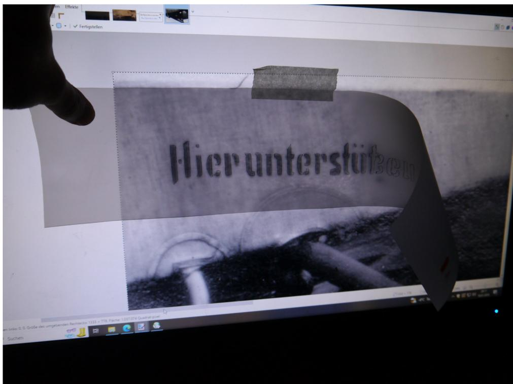
Diese abgepauste grobe Skizze kann jetzt auf das Reißbrett gelegt und vermessen werden. Was sich hierbei gezeigt hat, ist, dass die Buchstaben bei einer Höhe von 20mm eine konstruktive Breite von 13mm besitzen, die Strichstärke 4mm beträgt und der Abstand von Buchstabe zu Buchstabe ziemlich genau 5mm beträgt.
