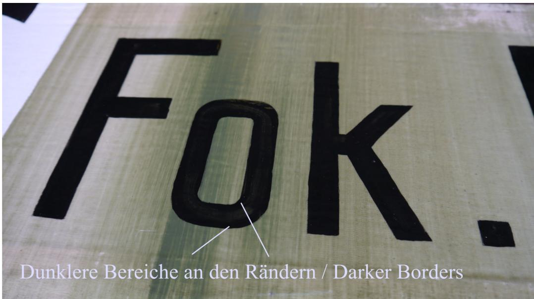
Fertig ausgezogener Schriftzug. Durch das Ausziehen mit Hand entsteht ein dunklerer Rand. Außerdem sind die Kanten niemals 100% gerade, sondern sehen immer frei Hand gezogen aus.
