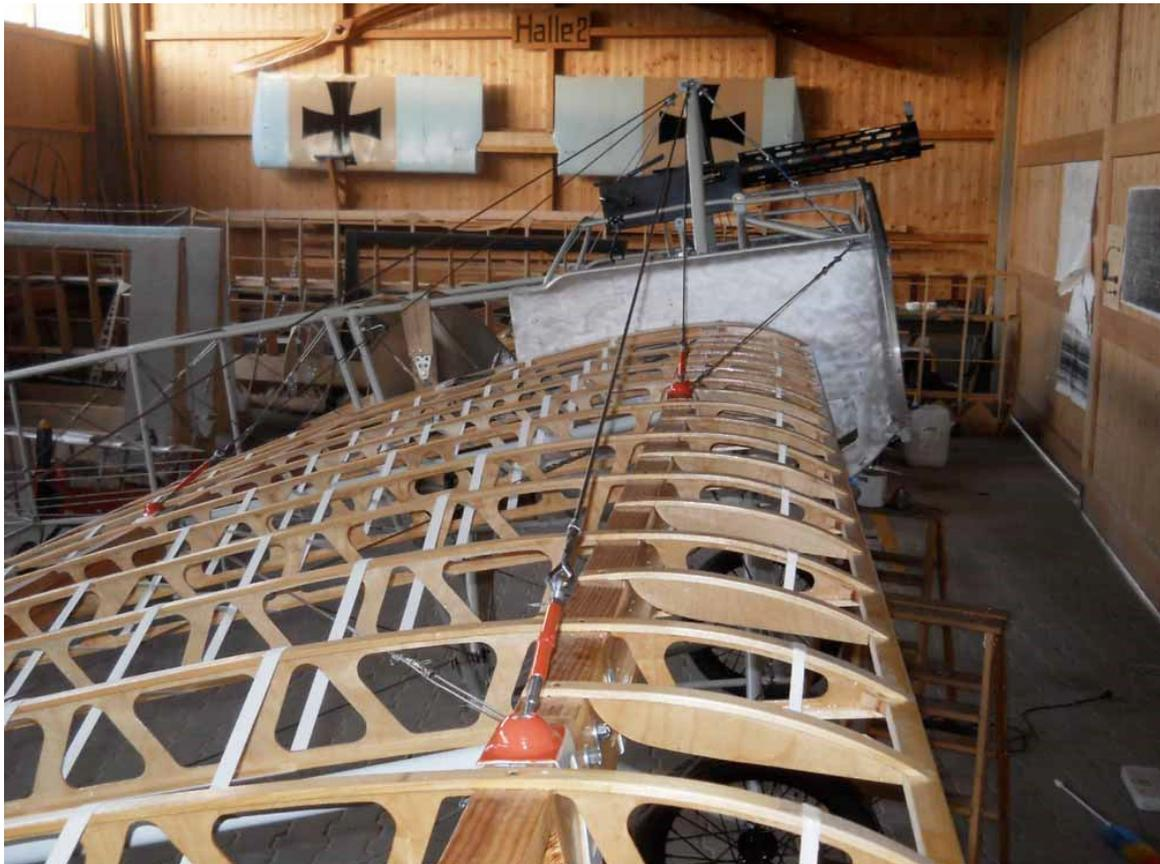
Zur Illustration: Rot markierte Spannschlösser können aus- und eingehängt werden, wenn die vier innenliegenden blau gestrichenen Spannschlösser gelöst werden.
