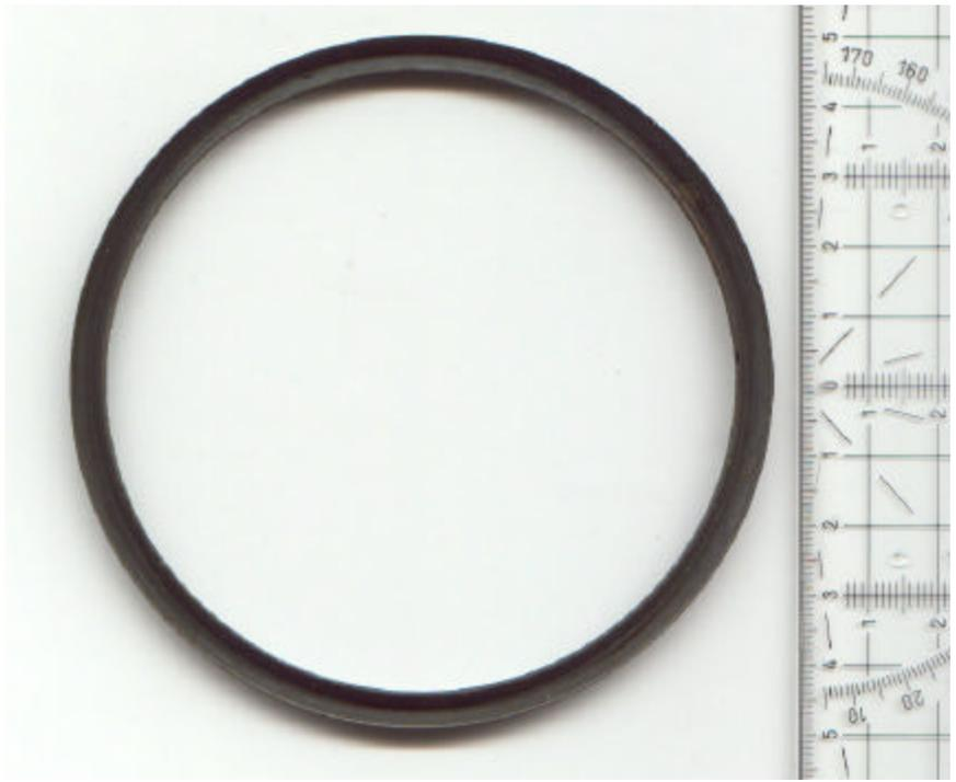
**Oben, das ist der innere Andruckring. Er wird vom Glas direkt auf das Ziffernblatt gedrückt und drückt dieses seinerseits gegen den äußeren Rand des Gerätegehäuses. Er ist aus gepresstem Stahlblech hergestellt. Des weiteren dient er als Abstandshalter zwischen Ziffernblatt und Glas, damit der Zeiger sich in diesem Zwischenraum frei bewegen kann.**
