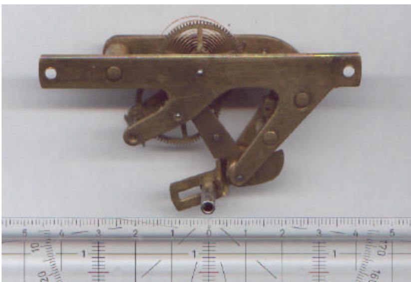
Unten, der Zeigerantrieb von hinten. Die Hauptaufgabe dieses Getriebes besteht darin, die Auf- und Abbewegung des inneren Schiebers in die Rotationsbewegung des Zeigers umzuwandeln.
