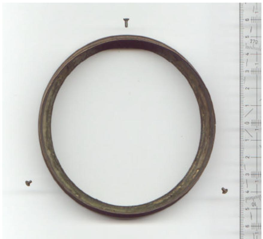
**Unten, der Ring von hinten. Er wurde aus 0,5mm starkem Messingblech gepresst und hat starke Patina angesetzt. Nach seiner Reinigung erschien er in strahlend leuchtender Farbe wie auf den nächsten Seiten zu sehen.**
