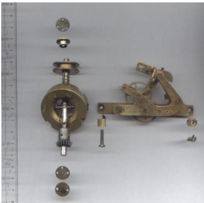
Unten, die Einzelteile der beiden Hauptgetriebe nebeneinander mitsamt aller Lagerungen und Befestigungen.
