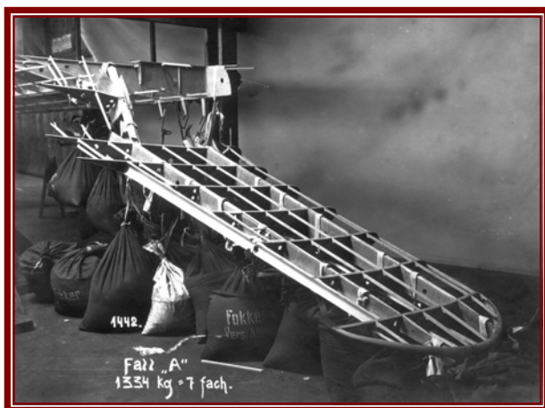
280. Auch bei Fokker wurden vor dem Start der Serienproduktion eingehende Belastungsversuche vorgenommen.
