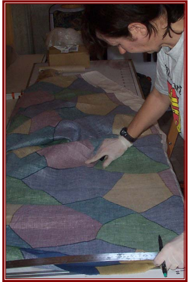
315. Vorbereitungen zum Bespannen des Rumpfes mit fünffarbigem Bespannstoff.
