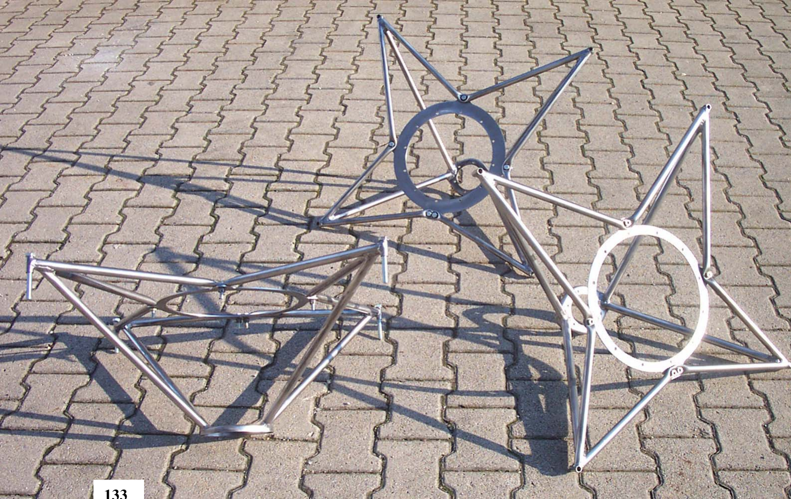
133. Drei fertige Motorhalterungen.
