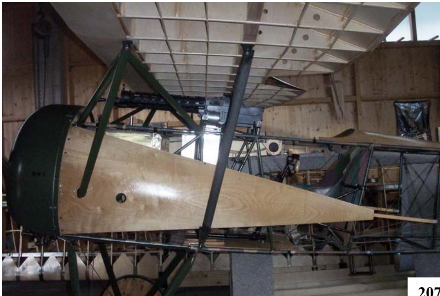
207 u. 208. Versuchsweiser Aufbau des Flugzeuges samt Flügel.
