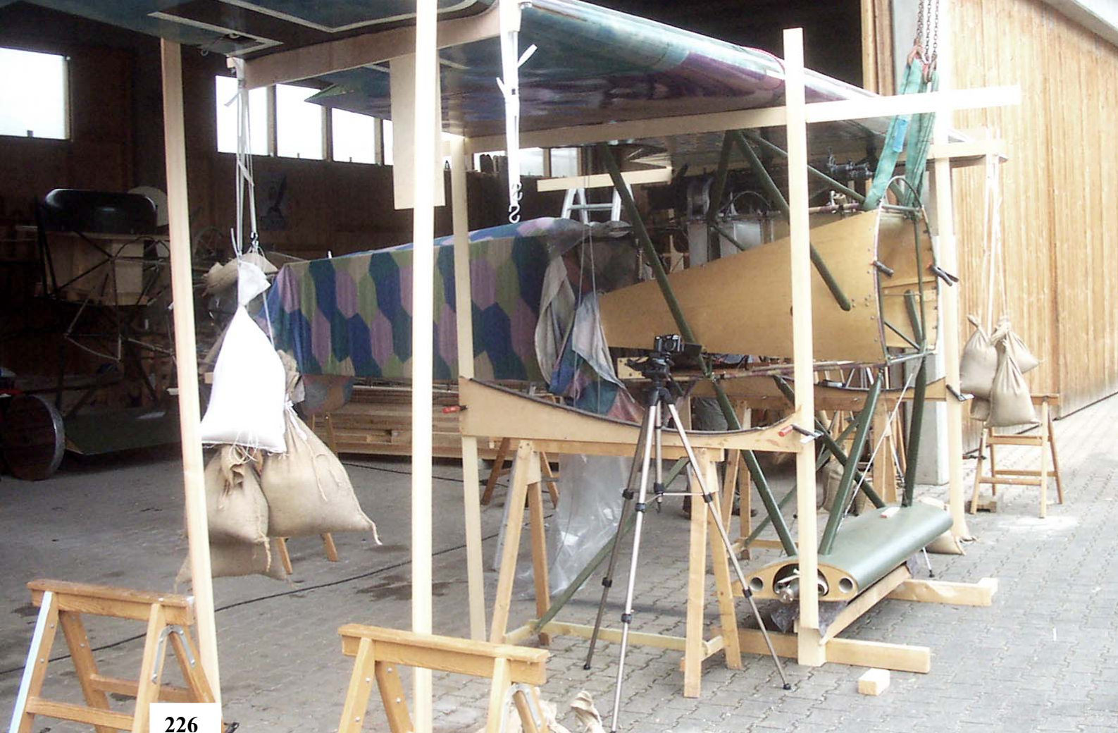
226. Belastung der Hinterkante des Flügels.
