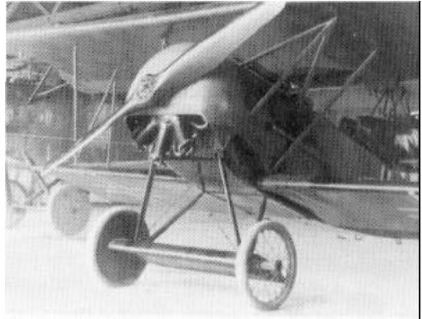
aus Stahlrohren und hatten V-Form, da sie an der Unterseite ja nur an einem Holm befestigt werden konnten.
