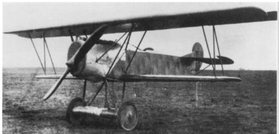
Die V.36 war der Letzte Prototyp der auf der V.11 basierte und von den Fokker Flugzeugwerken vor Kriegsende hervorgebracht wurde.
