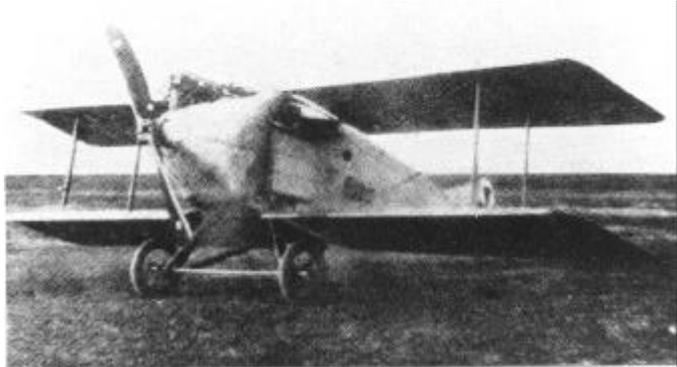
Das Fahrwerk wurde so geändert, dass beide Streben, wie bei der M.17 nach hinten liefen.
