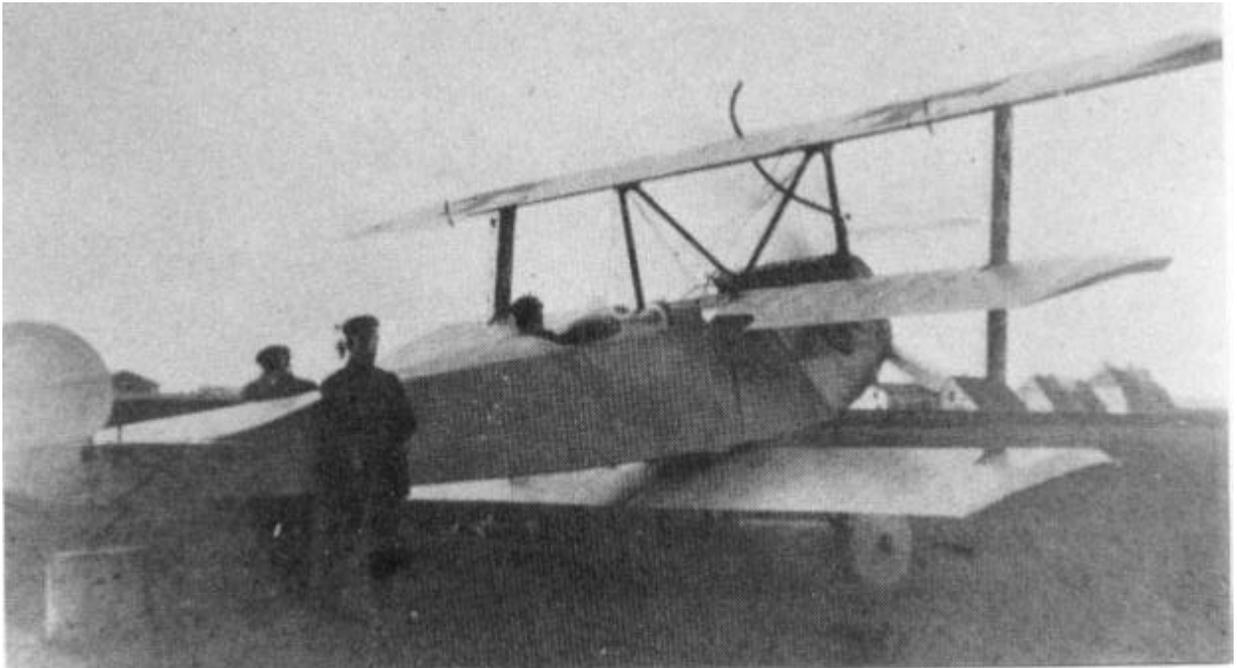
Die Fokker V.6. Oben in der ursprünglichen Form. Das untere Foto zeigt das Flugzeug, nachdem der Unterflügel in den Rumpf integriert wurde.
