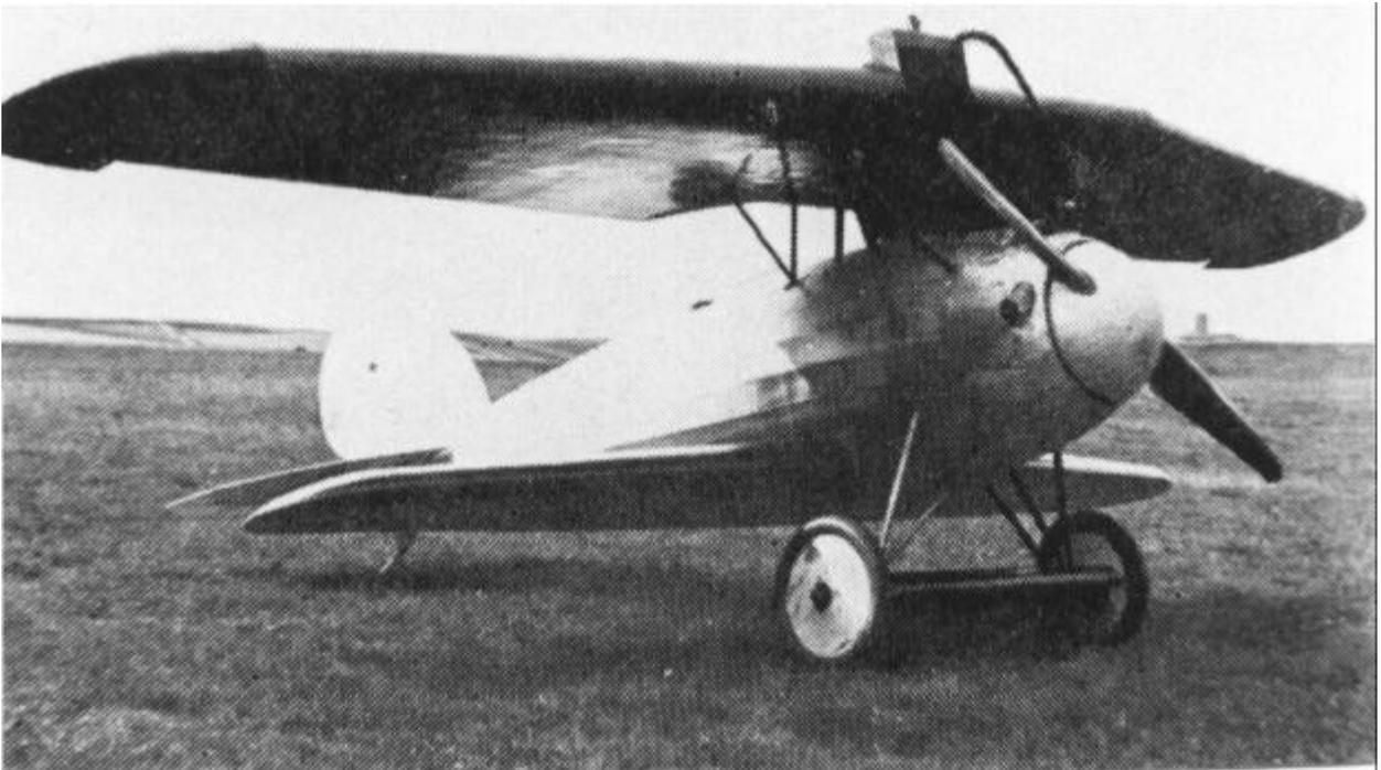
**Die V.3. Auffallend ist das durch Anregung von Richthofen abgeänderte Leitwerk, dass nun dem der Albatros-Flugzeuge entsprach.**
