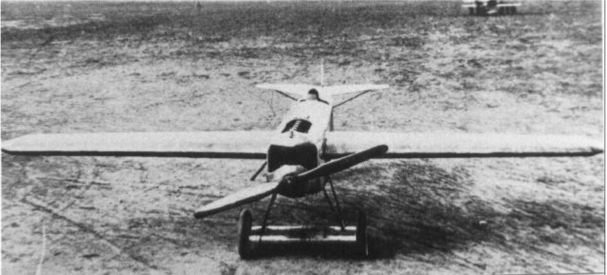
Dieses Flugzeug war eine Verfeinerung der V.20. Der Tragflügel war gefeilt und ein neues Seitenruder wurde angebracht. Die Spannweite der V.20 wurde verkürzt und der Rumpf verlängert.
